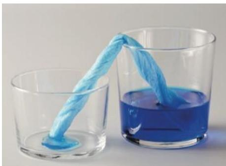
No experimento há água com corante no copo maior e água sem corante no copo menor. A capilaridade faz com que a água com corante seja puxada pelo papel até o outro frasco.
