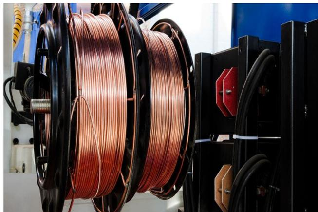
Os fios de cobre, usados em motores e circuitos, recebem uma camada de verniz isolante.
