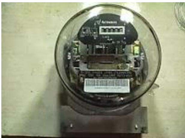
O relógio de luz é um aparelho que registra o consumo de energia elétrica de todos os aparelhos elétricos da casa, incluindo as lâmpadas. Para determinar o consumo mensal da residência, é calculado a diferença entre o valor dessa leitura e aquele encontrado na leitura realizada no mês anterior.
